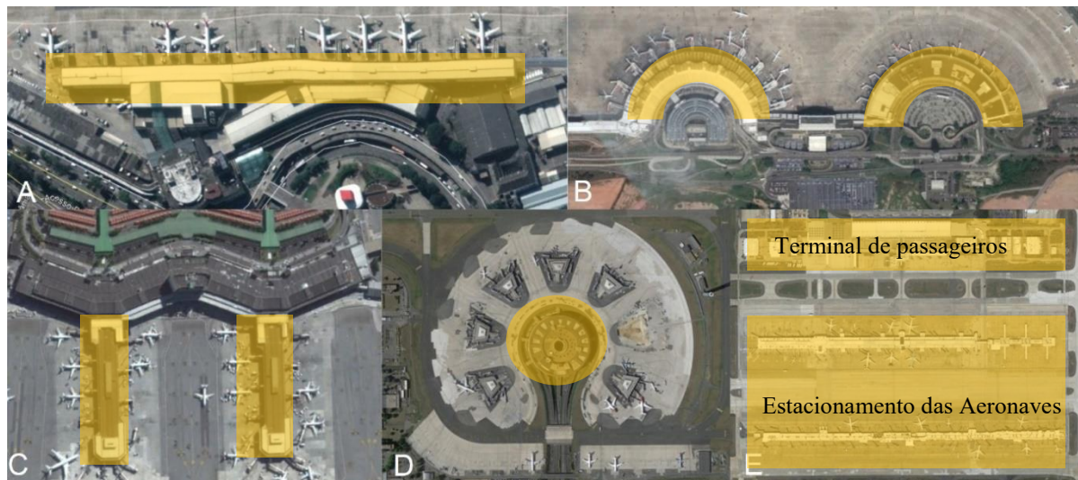
Figura 01: Ilustração das configurações físicas de cada tipologia aeroportuária
